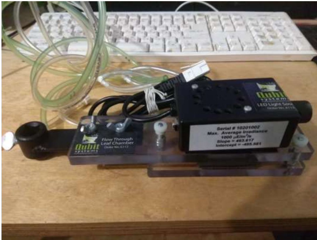
Листкова камера для дослідження \text{CO}_2 газообміну
