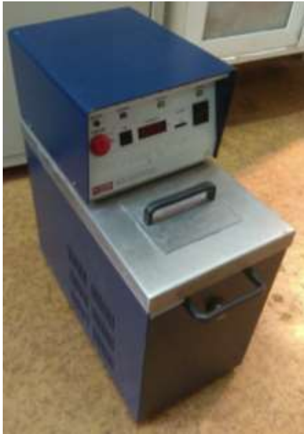
Циркуляційний термостат 2219 Multitemp II (LKB Bromma, Австрія)
