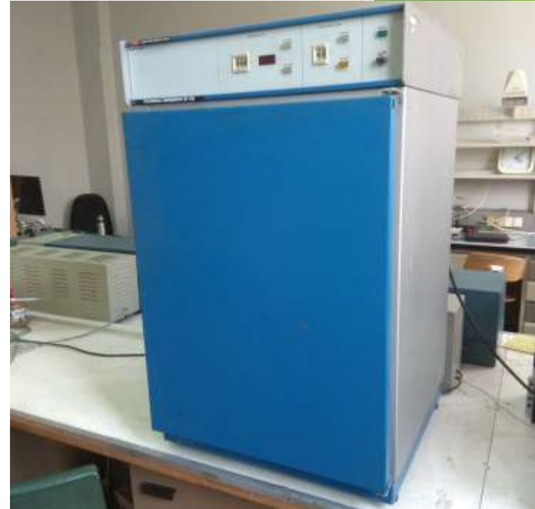
Термостат BT-120 (Лабораторні пристрої Прага)
