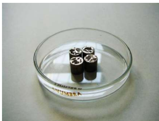
Рис. 21. Предметні столики з наклеєними і напиленими золотом біологічними зразками (фрагменти листка).
