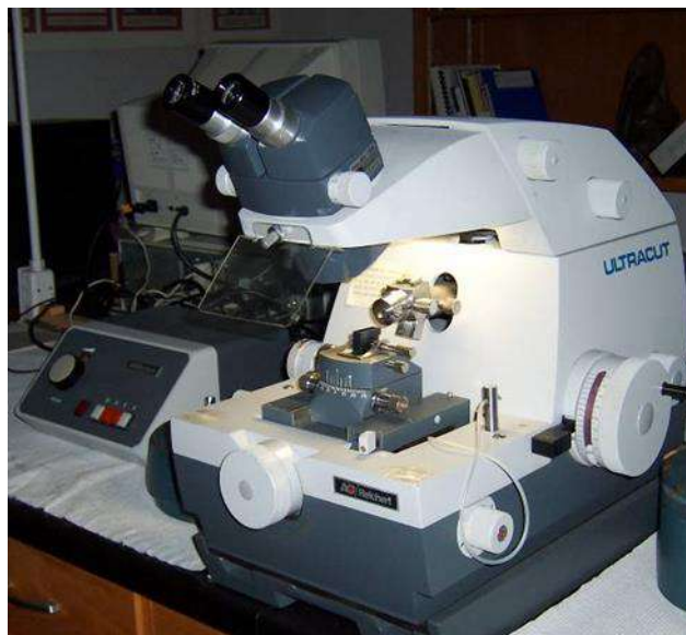
Рис. 8. Головний та керуючий блоки ультрамікротому Reichert Ultracut (Фото: http://www.microscopy.ou.edu ).
