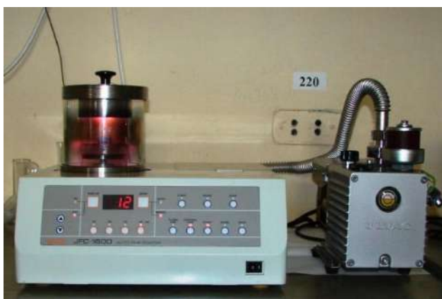
Рис. 20. Іонний напилювач зразків для сканувальної електронної мікроскопії JEOL JFC-1600.
